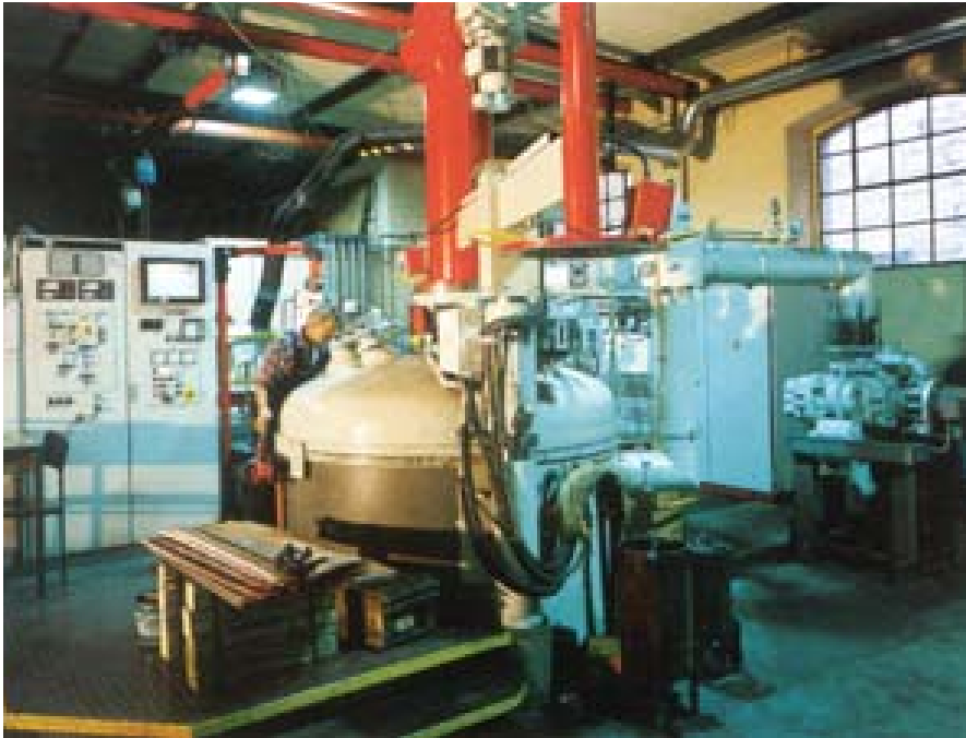
Die Schmelzmetall AG produziert seit 1959 hochwertige Kupferlegierungen unter Einsatz der Vakuum-Gießtechnik.
